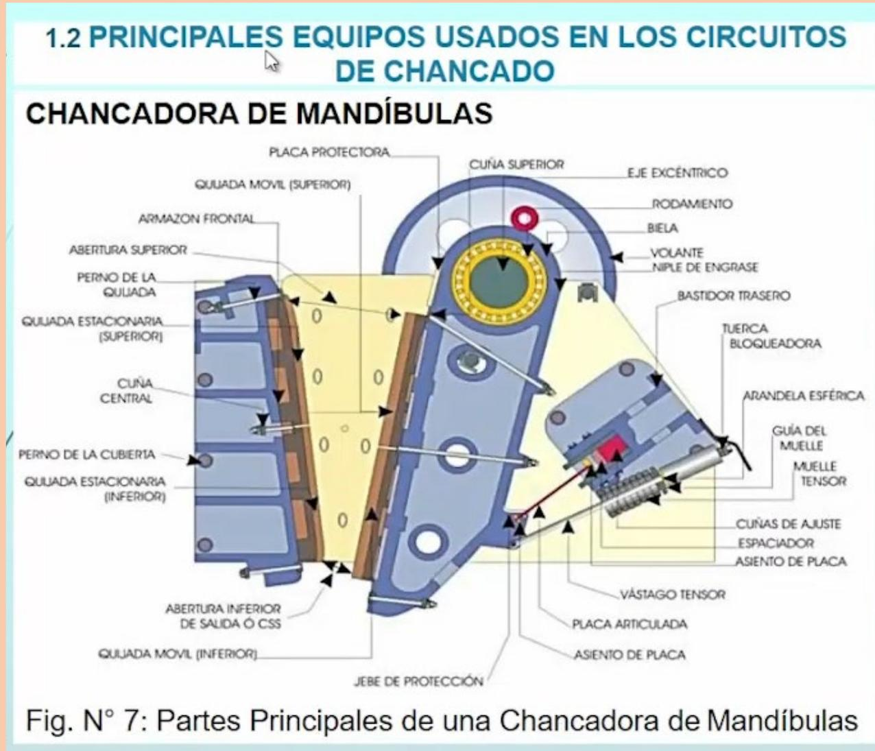
Fig. N° 7: Partes Principales de una Chancadora de Mandíbulas
