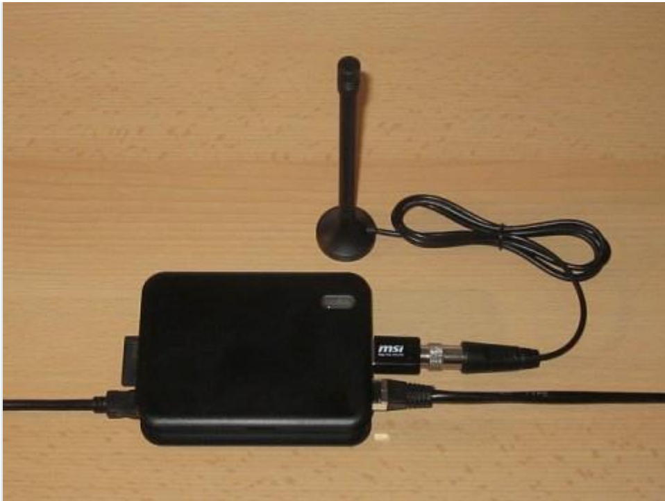
HAMServerPi: RaspberryPi mit DVB-T-Stick (z.B. für APRS-Empfang)
