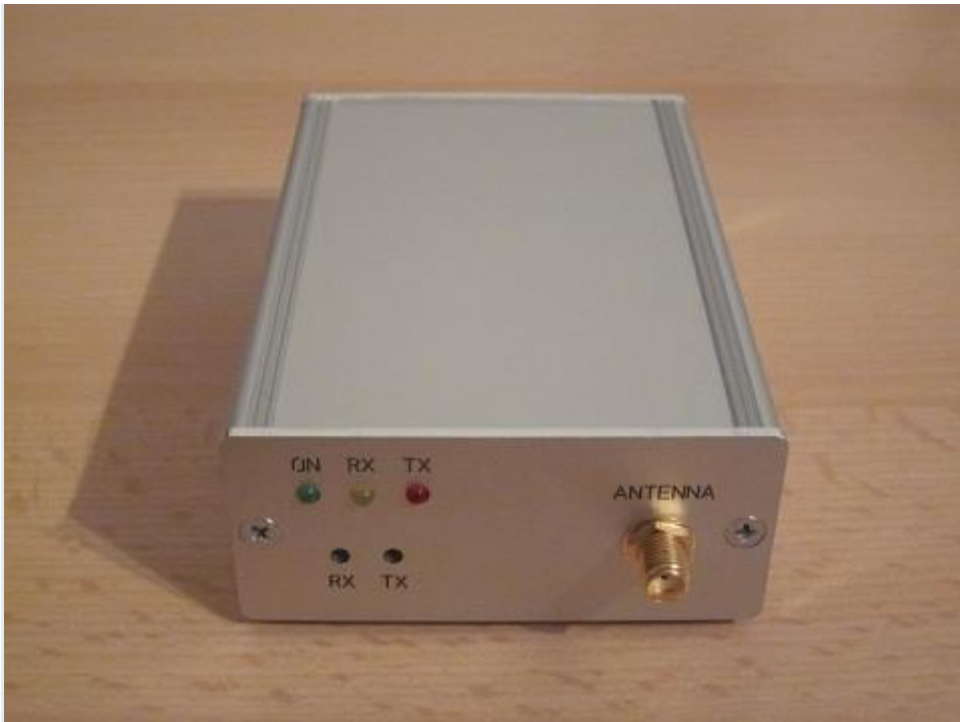
HAMServerPi RadioBox: Mit VHF- oder UHF-Modul und Antennenbuchse
