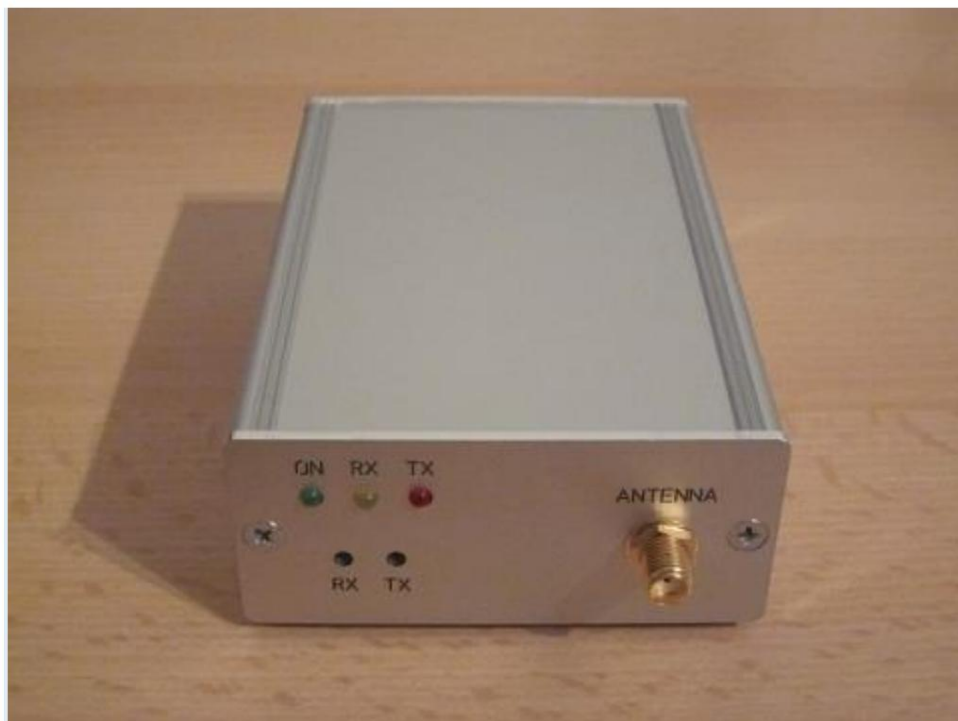
HAMServerPi RadioBox: Com módulo VHF ou UHF e soquete de antena
