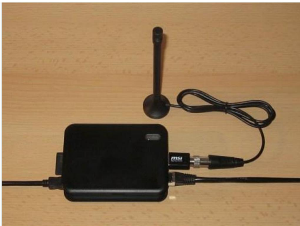
HAMServerPi: RaspberryPi com stick DVB-T (por exemplo, para recepção APRS)
