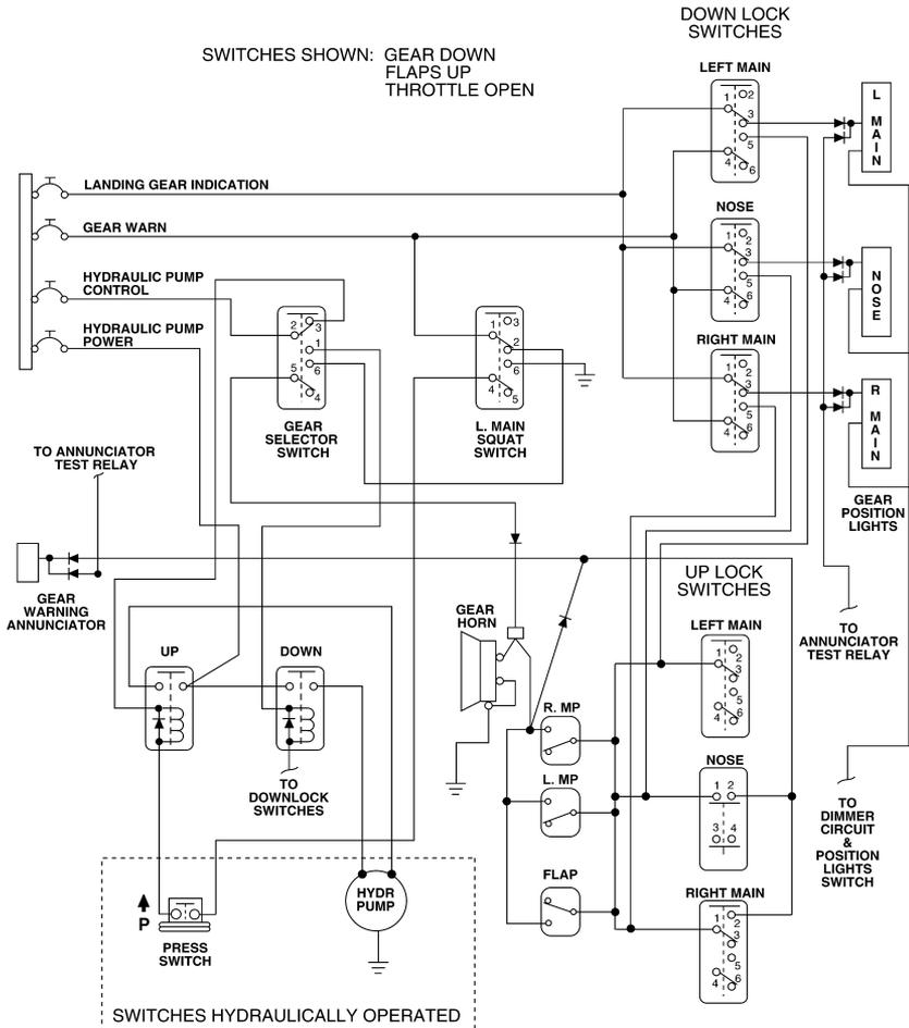
LANDING GEAR ELECTRICAL SYSTEM SCHEMATIC
