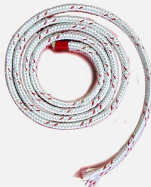
FIPRON Корд — инновационное автономное устройство пожаротушения. Имеет форму шнура, состоящего из композитного материала, представляет собой смесь микрокапсул с нагревательным веществом. Под воздействием огня в любой точке корда происходит инициирование нагревательного вещества с последующей химической реакцией по всей его длине. Реакция сопровождается тепловым разрядом, что приводит к разрыву всех микрокапсул и высвобождению огнетушащего вещества.
