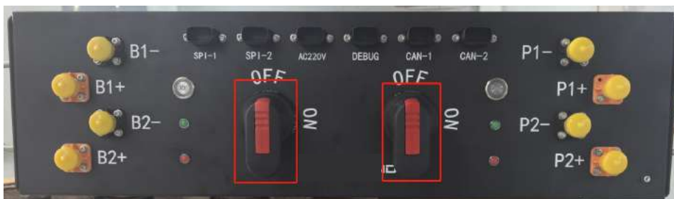
Figura 7-1-1 (1) Interruttore automatico HV BOX
