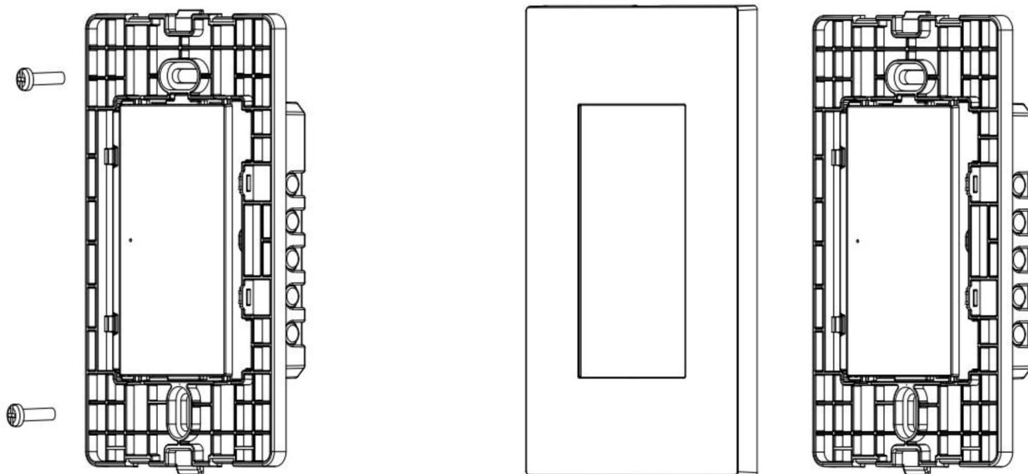
1. Luego de conectar los cables. Presente la parte trasera del Switch sobre la caja rectangular haciendo coincidir ambos tornillos de fijación
