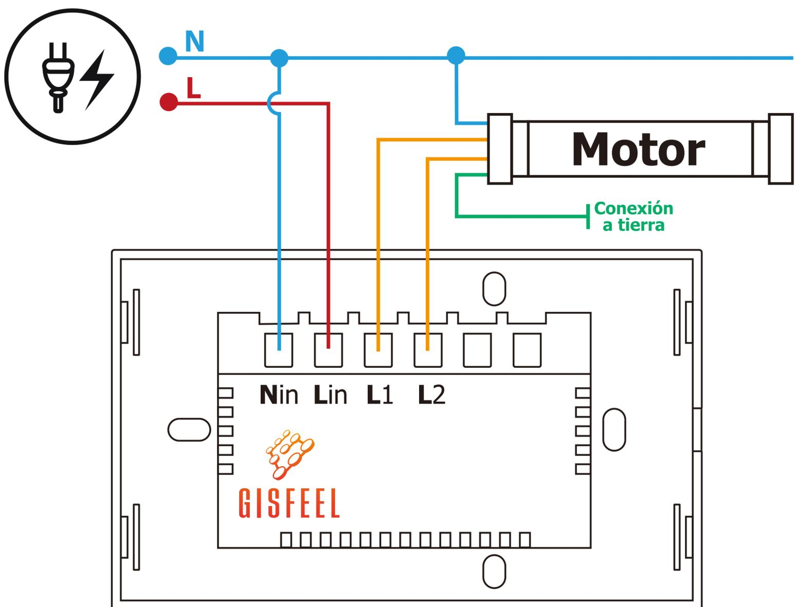
L1 y L2 emitirán 220v según se active apertura o cierre. Verifique que su motor sea apto para este tipo de conexiones y no activado por pulso sin tensión (contacto seco).
