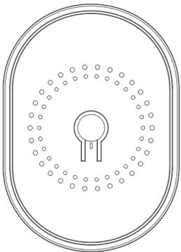
El pulsador en la parte trasera del Switch tiene la misma funcionalidad. Ambos pulsadores le permiten operar el ventilador por mas que no tenga acceso a Internet.
