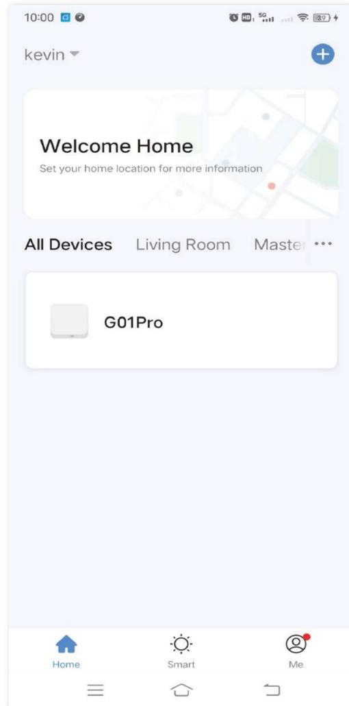
**b. AP Mode:** Seleccionar "Multimode Gateway (Zigbee + BLE)" de "Gateway Control", despues seleccionar "AP Mode", Cuando el HUB este titilando lentamente, conecte su smartphone a su dispositivo hotspot: "SmarLife-XXXX", despues vuelva al menu principal, donde aparece el dispositivo conectado
