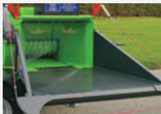
Système d'alimentation puissant rouleau et tapis ameneur en acier à dents d'entraînement soudées
