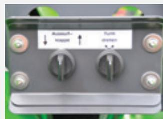
Chute orientable et clapet d'éjection réglable électriquement en option.
