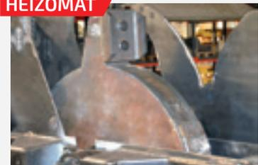
Soufflerie à volant d'inertie d'1 T = réserve de puissance
