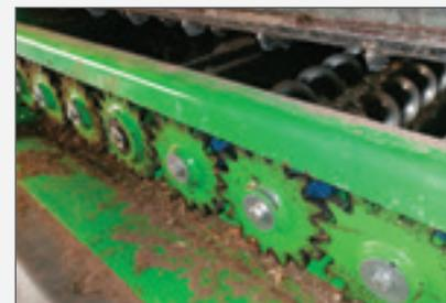
Vis de nettoyage sous la table d'alimentation (selon broyeur)
