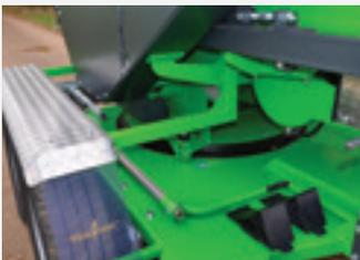
Plateau tournant à 270° pour orienter le broyeur selon le chantier.
