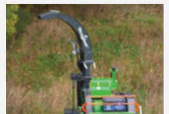
Chute et clapet hydro-electrique orientable et ajustable de série
