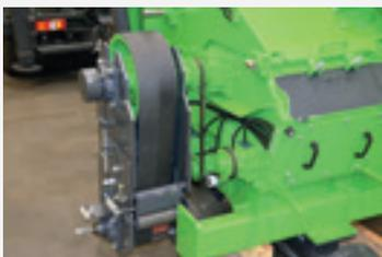
Transmission à courroies trapézoïdales
