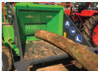
Système d'alimentation puissant : rouleau Ø 400 mm et tapis ameneur en acier à dents d'entraînement soudées.
