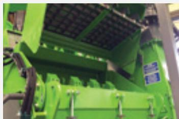
Double grille de calibrage permettant d'augmenter la surface de calibrage (en option).
