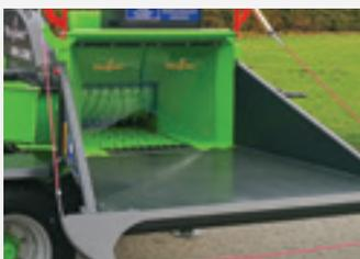
Système d'alimentation puissant à vitesse réglable. (rouleau et tapis ameneur en acier à dents d'entraînement soudées).
