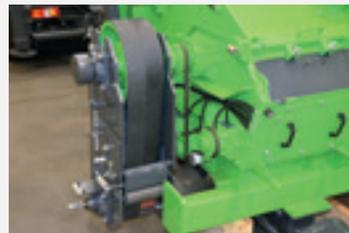
Transmission à courroies trapézoïdales
