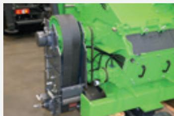
Transmission à courroies trapézoïdales
