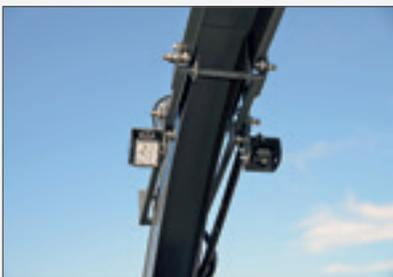
Caméra et éclairages LED placés sur la chute d'éjection pour une meilleure visibilité
