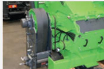
Transmission à courroies trapézoïdales
