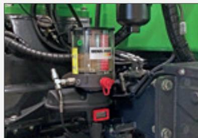
Lubrification automatique centralisée facile et rapide d'utilisation
