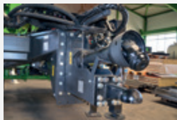
Hauteur d'attelage ajustable 500, 600, 900 ou 1000 mm
