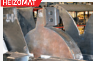
Soufflerie à volant d'inertie d'1 T = réserve de puissance ⊖ conso, ⊖ régl, ⊖ sollicitation moteur et rotor ⊕ puissance/force, ⊕ régularité
