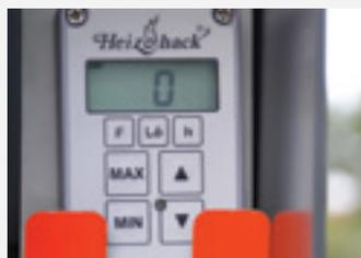
Système de commande automatisé Hei@hack HE 002 pour réguler l'avancée du bois en fonction de la puissance d'entraînement.
