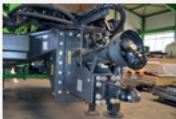
Hauteur d'attelage ajustable 500, 600, 900 ou 1000 mm
