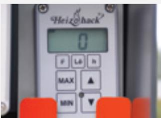
Système de commande automatisé (idem gros broyeurs) pour réguler l'avancée du bois à déchiqueter
