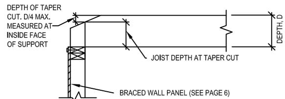
**CEILING JOIST TAPER CUT (FIGURE R802.7.1.2)**
