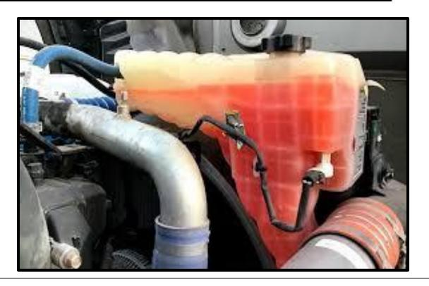
Depósitos de refrigerante y de dirección asistida
