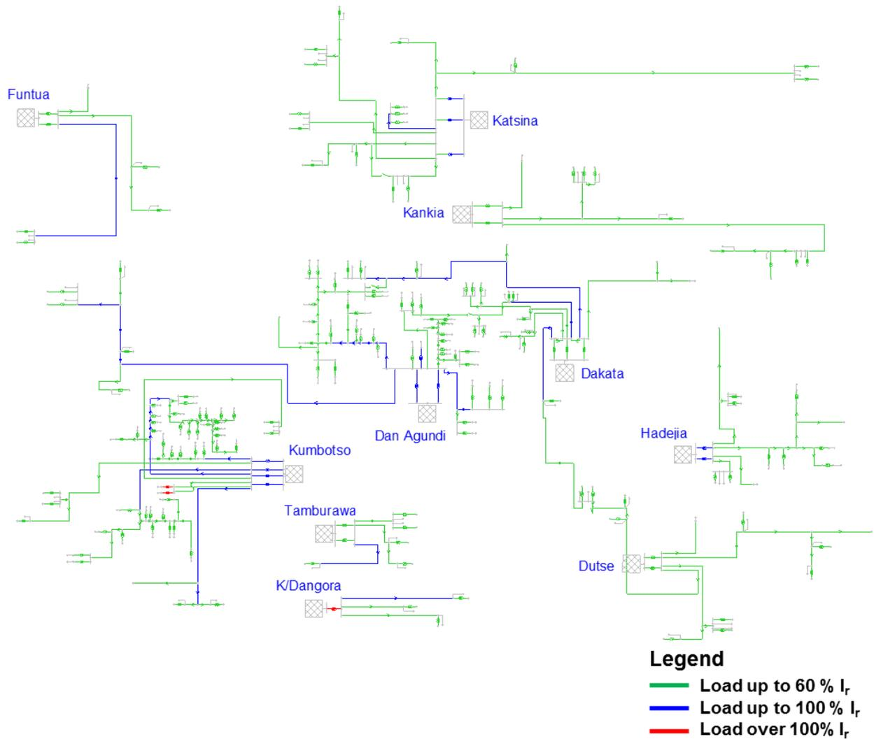
FIGURE 14: KANO DISCO NETWORK MODEL ON SINCAL
