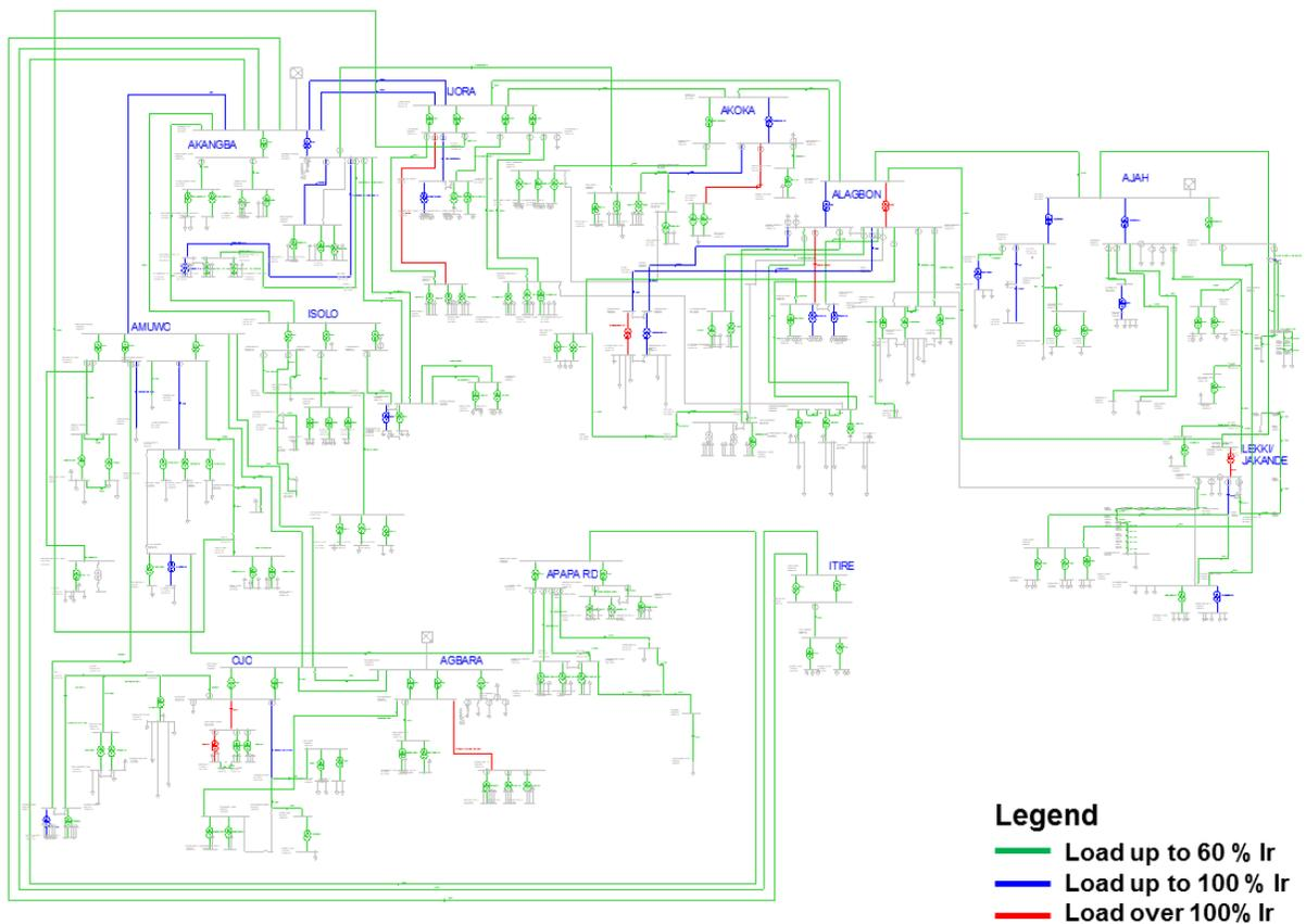
**FIGURE 12: EKO DISCO NETWORK MODEL ON SINCAL**
