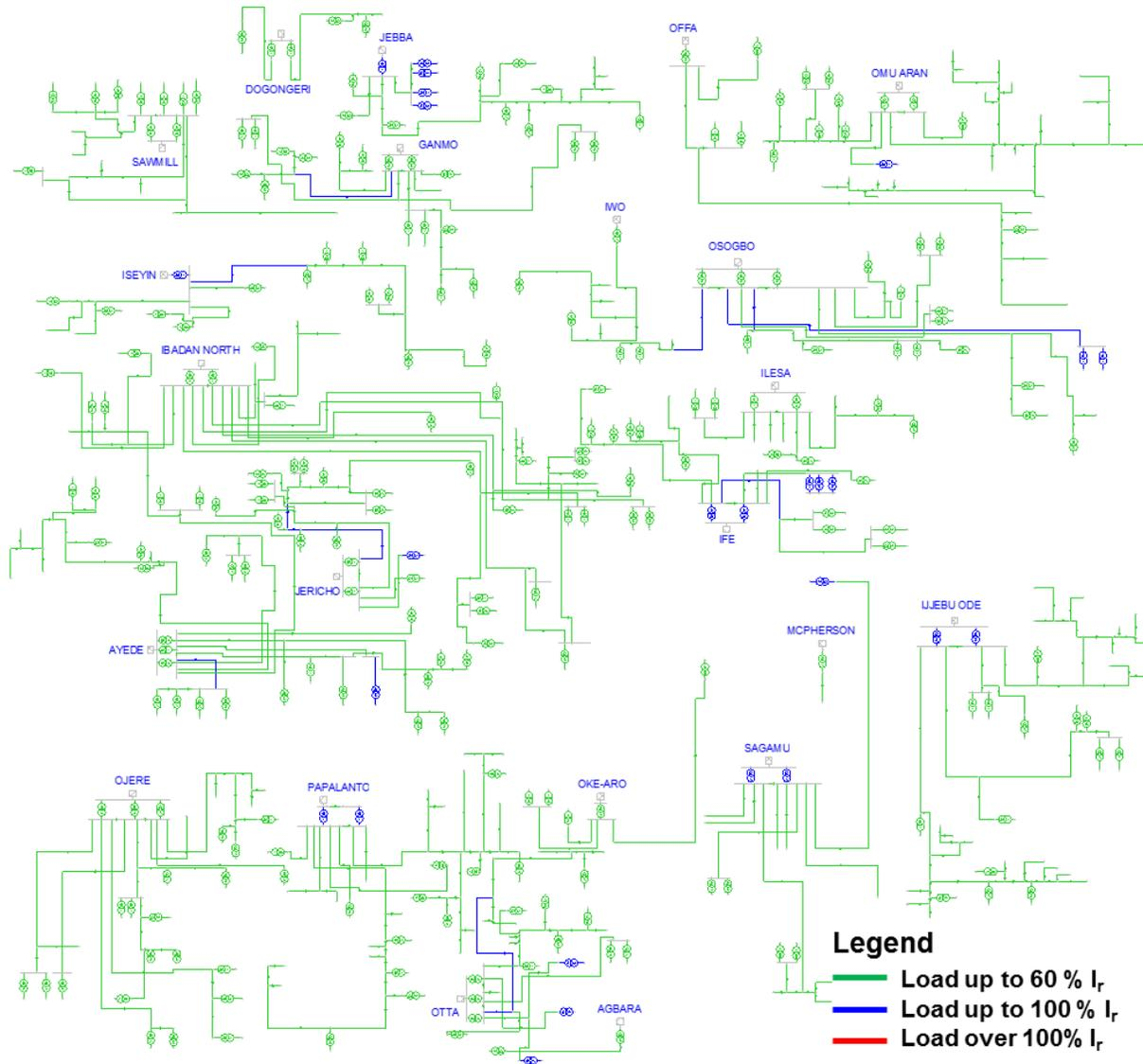
**FIGURE 13: IBADAN DISCO NETWORK MODEL ON SINCAL**
