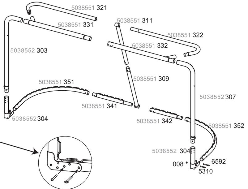
1. Commencer l'assemblage par la base du but et progresser vers le haut. Suivre le diagramme. Remarque : tirer les broches des deux pieds pliables et les déplier. Réinsérer les broches pour verrouiller la position avant l'assemblage.
