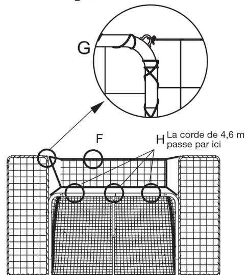
**Figure 4** Filets du haut du filet d'arrêt
