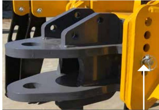
FIG 8.0 LYNCH PIN SECURING HITCH
