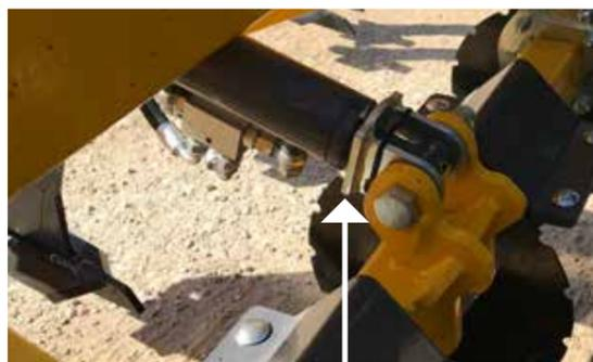
FIG 18.0 LOCATION OF DISC RAM SPACERS
