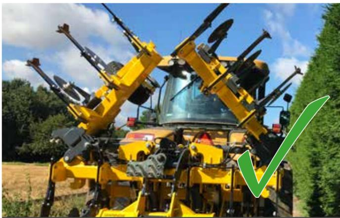
FIG 16.0 **CORRECT** FOLDING POSITION FOR GRANGE 6M LDT FOR TRANSPORT
