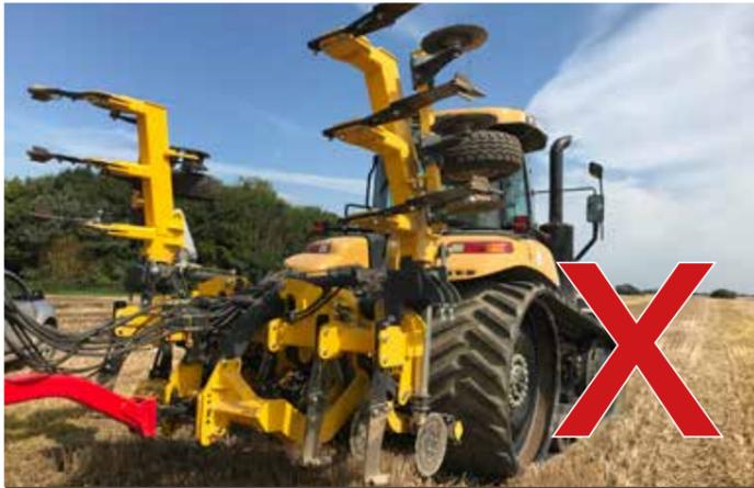
FIG 15.0 **INCORRECT** FOLDING POSITION FOR GRANGE 6M LDT FOR TRANSPORT
