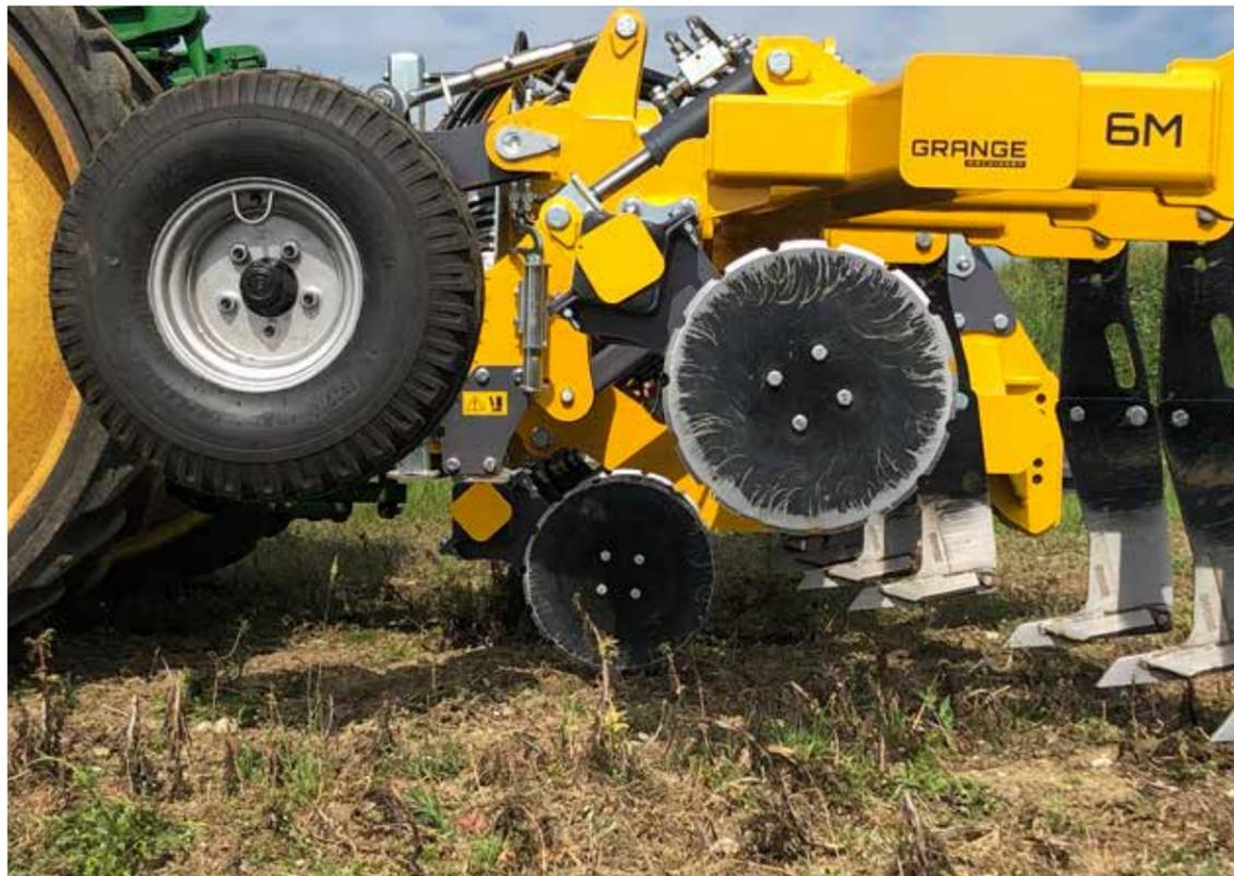
FIG 5.0 CORRECT LINKAGE CONFIGURATION
