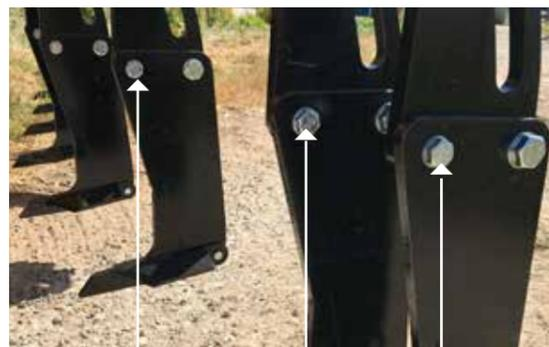
FIG 16.0 SHEAR BOLT LOCATION
