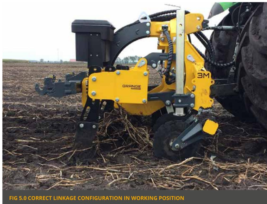
**FIG 5.0 CORRECT LINKAGE CONFIGURATION IN WORKING POSITION**
