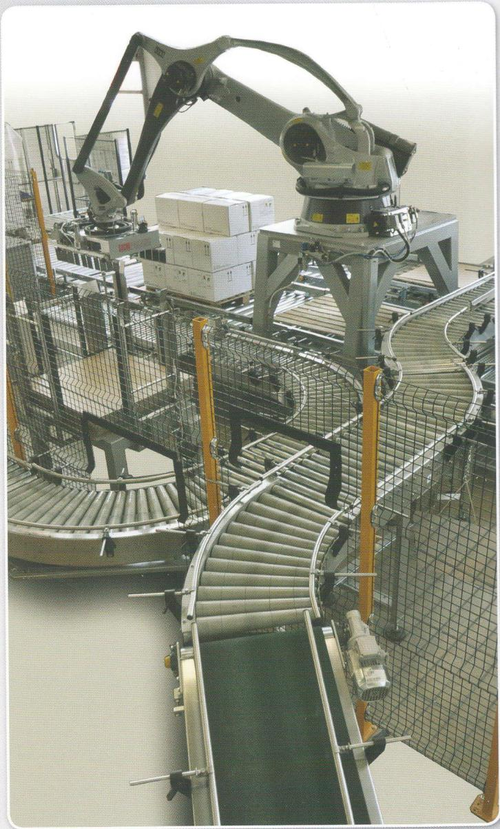
Proyección y construcción de islas con robot antropomorfos con herramientas de agarre personalizadas para la manipulación, encartamiento o paletización de multiples productos. El robot puede atender varias lineas contemporaneamente con una notable velocidad y presición.
