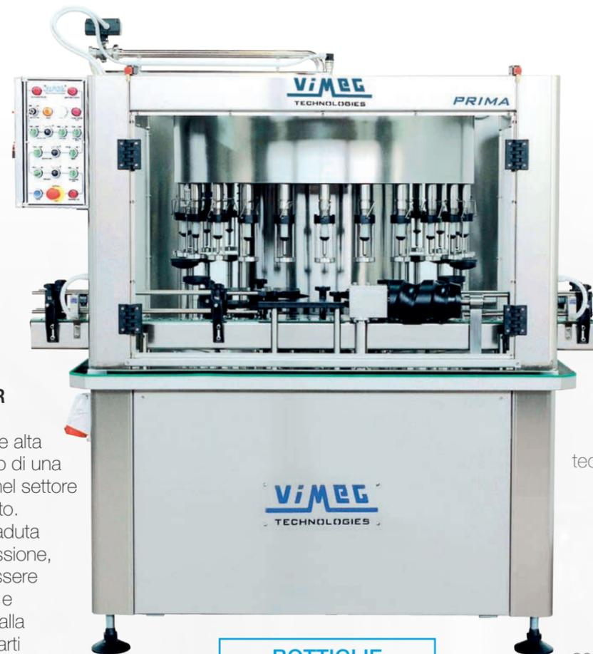
La riempitrice rotativa PRIMA R è realizzata con materiali di qualità e alta tecnologia, risultato di una lunga esperienza nel settore dell'imbottigliamento. La riempitrice, a caduta o a leggera depressione, è concepita per essere facilmente lavabile e sterilizzabile. Oltre alla struttura, tutte le parti a contatto con il prodotto sono in acciaio inox.
