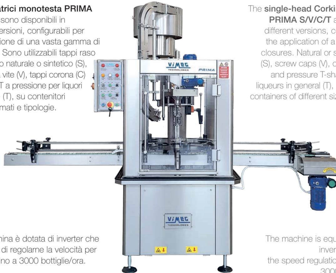
La macchina è dotata di inverter che permette di regolarne la velocità per lavorare fino a 3000 bottiglie/ora.
