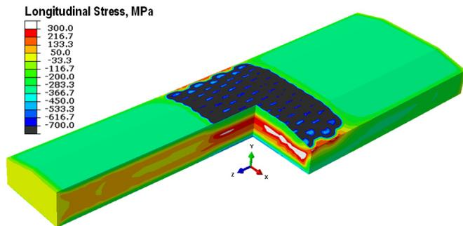
**FIGURE 10 - RESIDUAL STRESSES IN THE LONGITUDINAL DIRECTION AFTER LASER PEENING WITH PRELOAD.**
