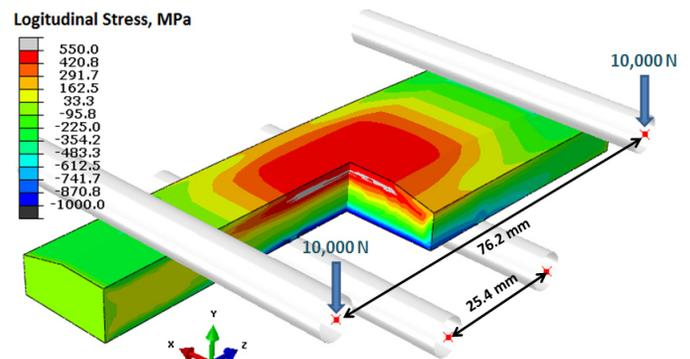
**FIGURE 9 - STRESS DISTRIBUTION UNDER PRELOAD BEFORE LASER PEENING.**
