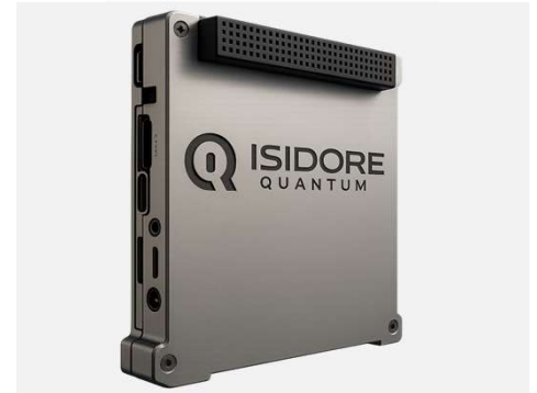
Dispositivo Espacial COMSEC Isidore Quantum® —un módulo de cifrado compacto y resistente a la radiación. El diseño de la carcasa es idéntico en toda la familia Isidore Quantum HTSR y HTSC, con variaciones de tamaño según la función.
