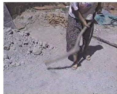
Fotoğraf 25 : Dibekle Çamurun Öğütülmesi (Akçaova, 23 Haziran 2003
