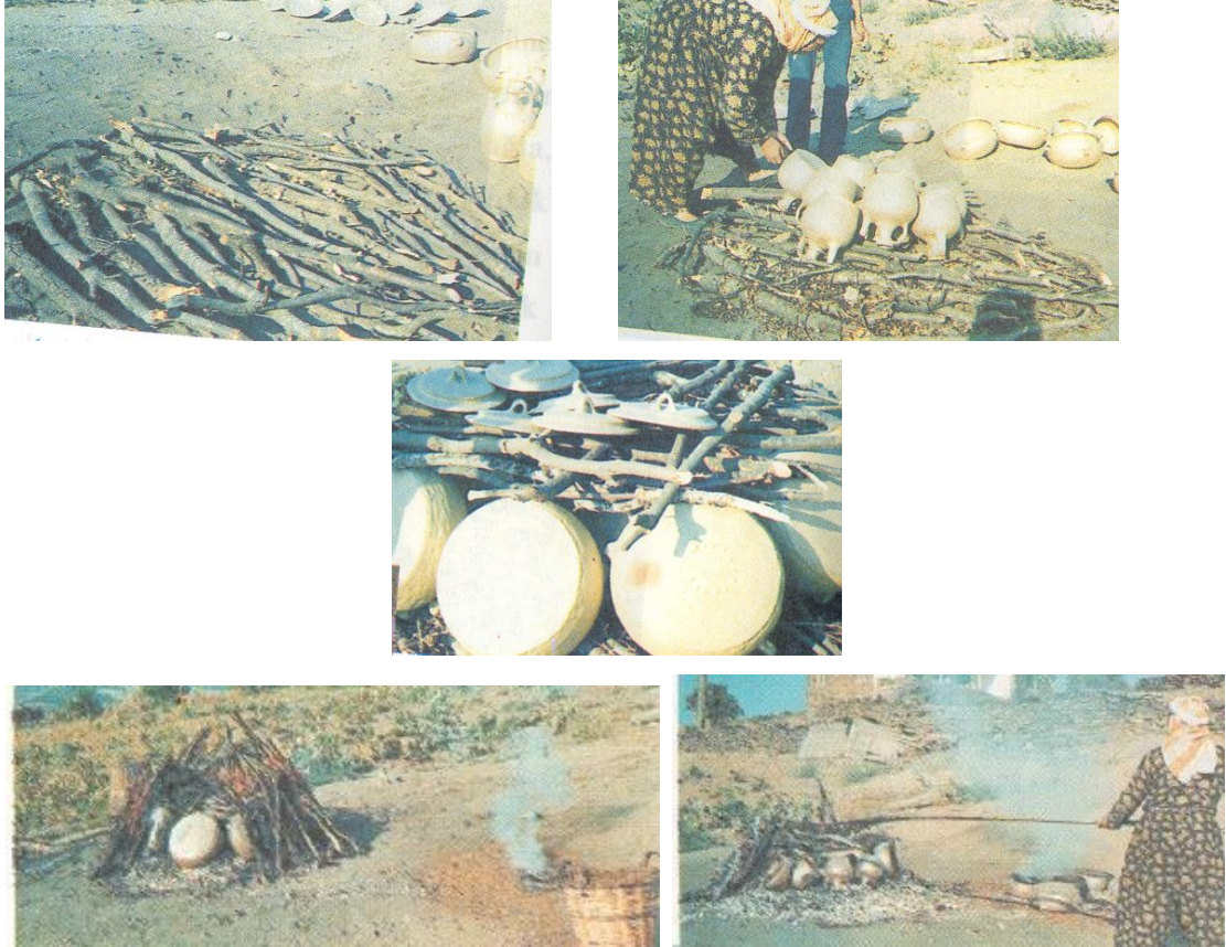
Fotoğraf 53 : Gökeyüp Örneğinde Aşamalarıyla Sahra Fırın Pişirimi (Ayşegül Türedi Özen, Geleneksel Çömlek Sanatı Anadolu Üniv. Yayınları Eskişehir, 2001 s.100-103)
