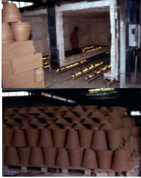
Fotoğraf 74 : Kamara Tipi Gazlı Fırın Örneği Kullanım Yerleri : Menemen-Atça
