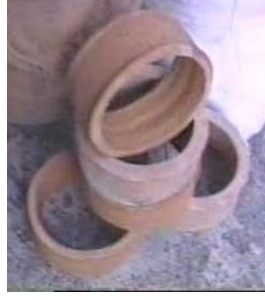
Fotoğraf 132 : Künk kullanımında Yardımcı Üretimler (Bilezik ve Dirsek)
