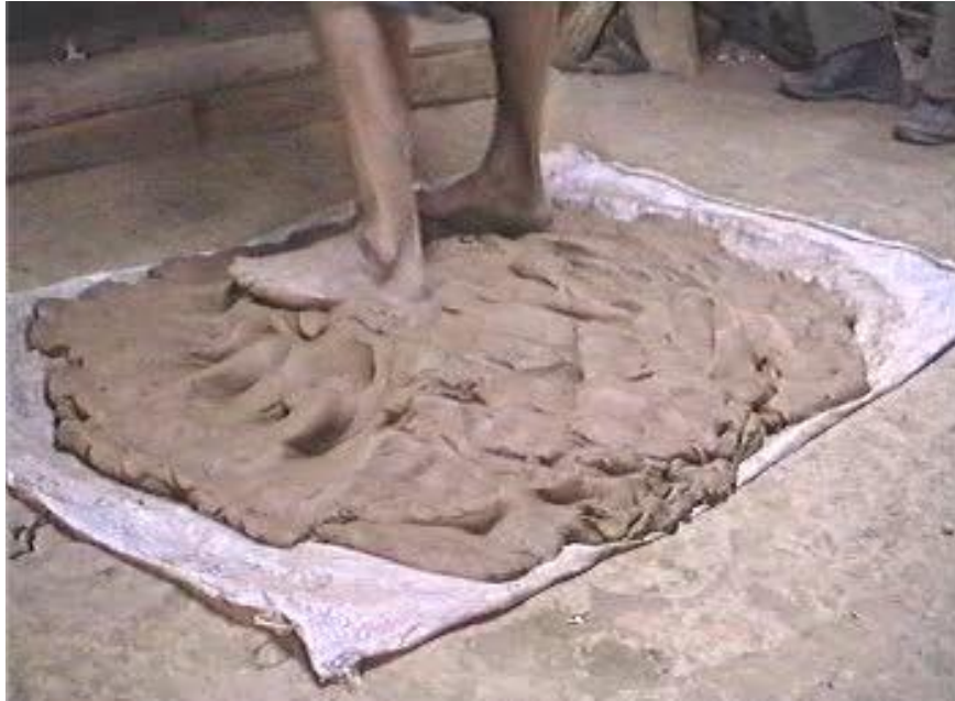
Fotoğraf 34 : amurun Ayakla zdeřleřtirilmesi
