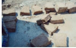
Fotoğraf 3: Kemer yapımında kullanılan kerpiçler
