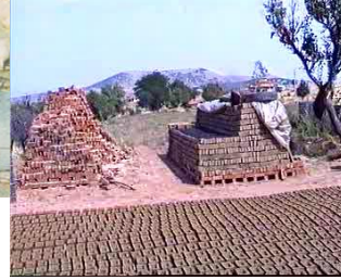
Fotoğraf 34: Kula tuğla pişirimi solda bitmiş sağda yerleştirilmekte olan
