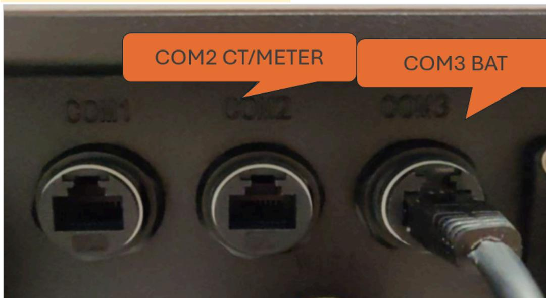
Collegare un **cavo Lan diretto** dalla **porta 1** chiamata anche **porta CAN** della batteria alla porta **COM3** dell'Inverter. (si può usare un qualsiasi cavo Lan)
