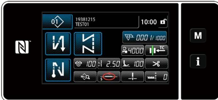
Drei unterschiedliche Zählertypen sind verfügbar: Spulenfadenzähler, Nähvorgangszähler und Produktionszeitzähler.
