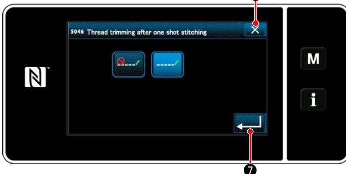
3) Versetzen Sie die Funktion für Fadenabschneiden mit kürzerem Restfaden in den Zustand EIN/AUS (Mit/ohne Verdichtungsstiche).
