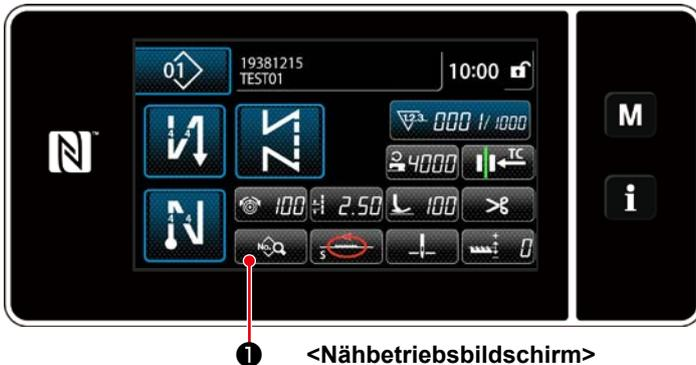
Auf dem Nähbetriebsbildschirm, der angezeigt wird, falls freies Nähen, Konstantmaß-Nähen oder Mehrlagen-Nähen ausgewählt wird, drücken Sie
