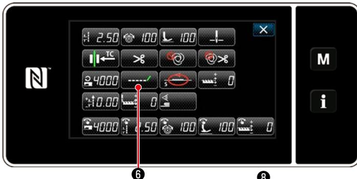
2) Bringen Sie "S046 Thread trimming after one shot stitching (Fadenabschneiden mit kürzerem Restfaden)" durch Drücken von
