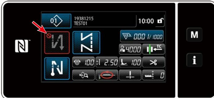
Das Rückwärtsnähtmuster am Nahtanfang kann verwendet werden, wenn die Funktion für Rückwärtsnähen am Nahtanfang in den EIN-Zustand versetzt wird (das Zeichen
