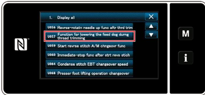
4) Wählen Sie "U057 Function for lowering the feed dog during thread trimming (Funktion zum Absenken des Transporteurs während des Fadenabschneidens)".
