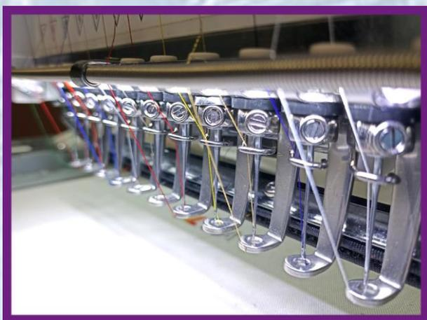
Durch die Verwendung von 12 Nadeln steht Ihnen eine reiche Farbauswahl für Ihre Stickmuster zur Verfügung. Fadenschneiden und Farbwechsel im Nahtprogramm erfolgen automatisch.
