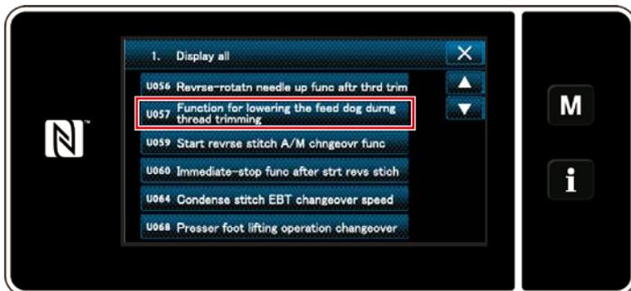
4) Sélectionner « U057 Function for lowering the feed dog during thread trimming (Fonction d'abaissement de la griffe d'entraînement pendant la coupe du fil) ».
