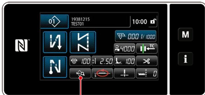
La phase entre l'aiguille et l'entraînement peut être réglée sur le panneau de commande.
