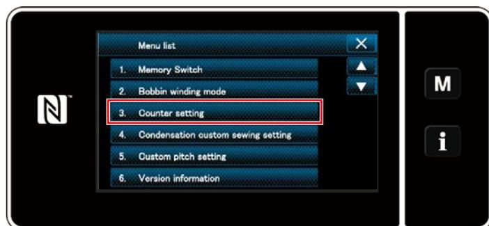
2. Sélectionner le "Counter setting (Réglage du compteur)".
