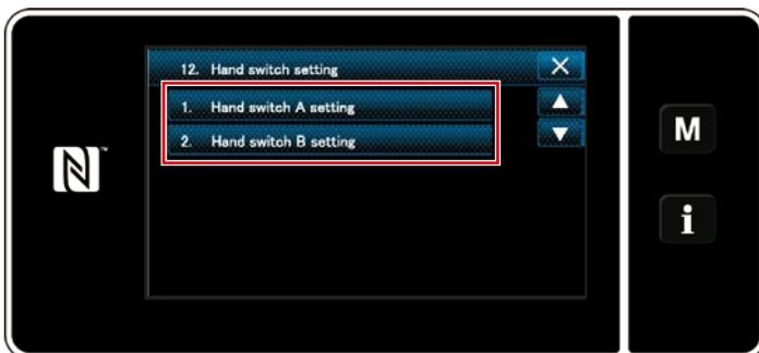
3) Sélectionner l'interrupteur à régler.
