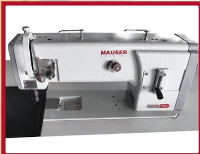
Bras de machine allongé à 357 mm à droite de l'aiguille pour faciliter la manipulation de matériaux volumineux.
