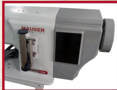
Entraînement direct intégré de 750 W en combinaison avec coupe-fil automatique, relevage de pied et verrouillage de la couture. (option)
