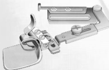
41-A78 Ourleur avec courbure en haut, rabattable Largeurs d'ourlet disponibles de 6.4mm à 25.4mm. Pour les articles fermés en rond
