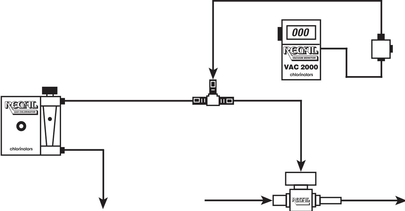
**DRAWING NO. 4 - TYPICAL AUTOMATIC SWITCHOVER SYSTEM INSTALLATION**
