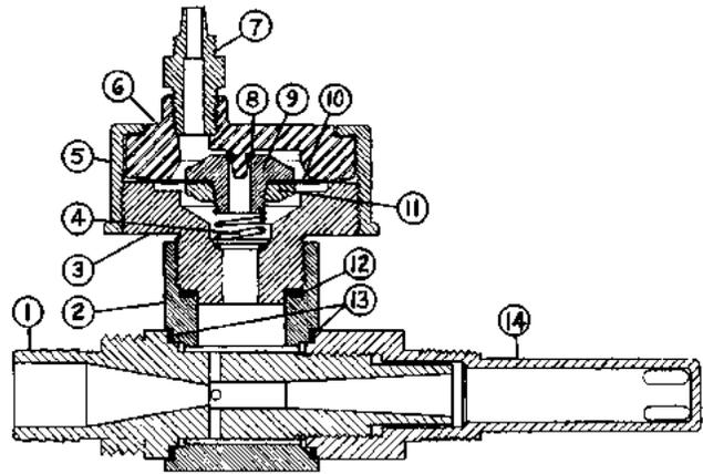
EJECTOR MODEL A-921S 100 PPD (2000 g/hr.)
