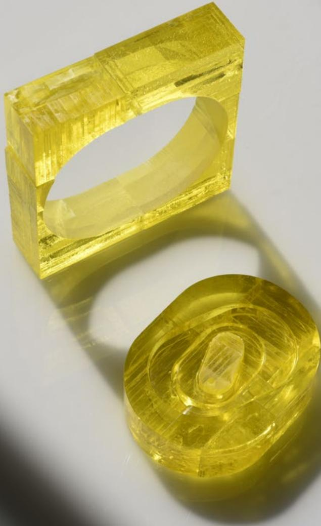
Für die Kollektion wird aus mehreren Einzelteilen ein großer Materialblock zusammengesetzt. Aus diesem werden dann die Formen der Schmuckstücke mittels Wasserstrahl herausgeschnitten. Alle Teile sind so ineinander verschachtelt, dass das Material möglichst effizient genutzt wird. Der Rand, der nach dem Scheiden übrig bleibt kann Ausgangspunkt für einen neuen Block sein, aus dem wiederum Teile ausgeschnitten werden können.
