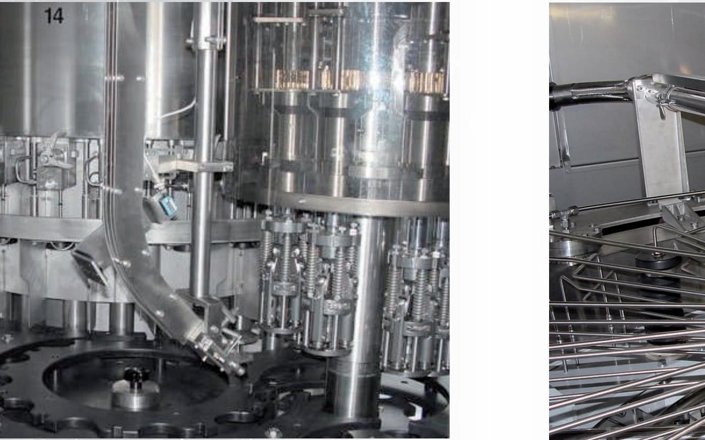
Il passaggio da un formato bottiglia ad un altro non richiede nessuna variazione in altezza del serbatoio e dei comandi. Questo evita perdite di tempo nel cambio formato ed inutili e difficilissime operazioni di regolazione. La bottiglia entra nella coice e rimane guidata fino all'uscita del tappatore, evitando il contatto con le altre bottiglie, abbassando notevolmente il coefficiente di rumorosità e mantenendolo adeguato alle normative vigenti. MULTIBLOK SPECIALE CON 4 TIPI DI CHIUSURA
