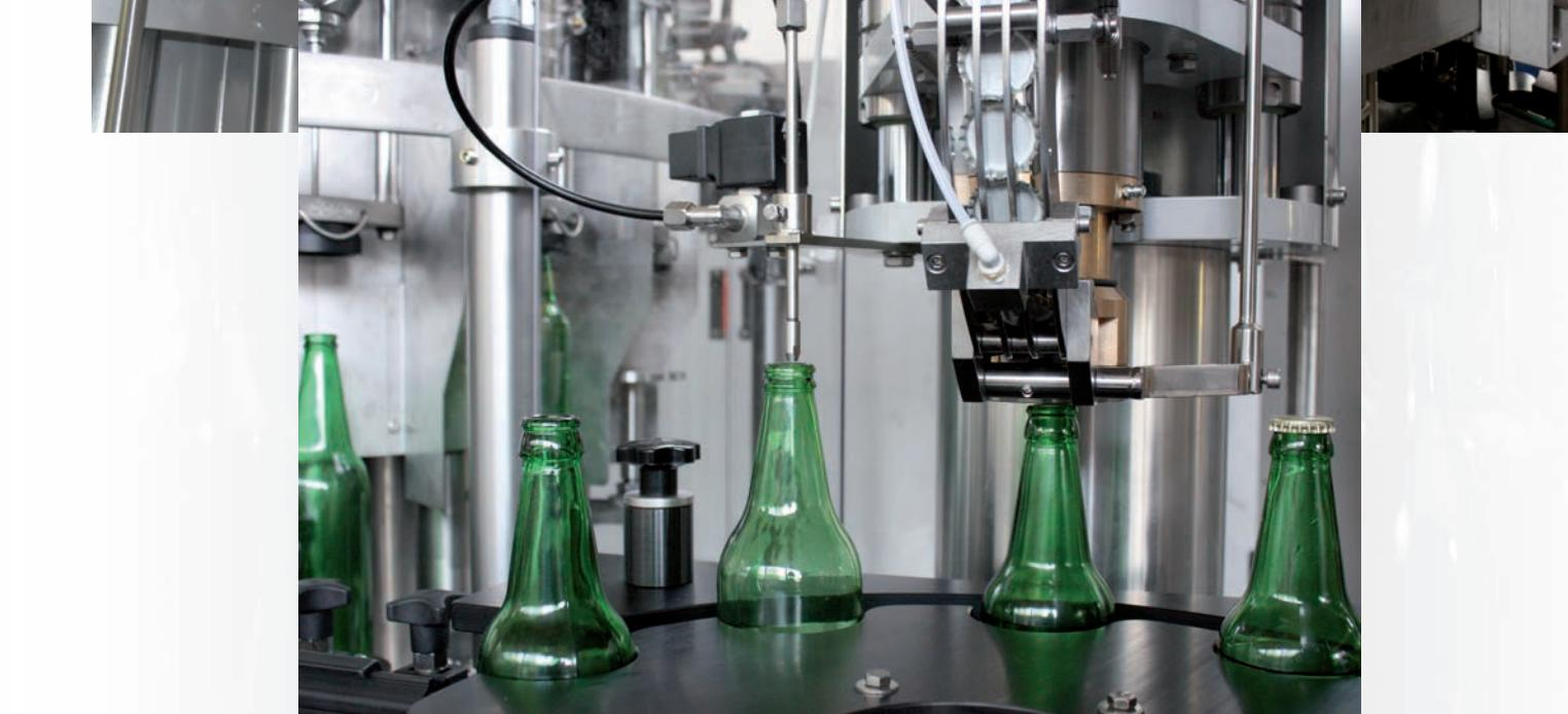
Livello in bottiglia centralizzato / Level in bottle centralized / Nivel en botella centralizada
