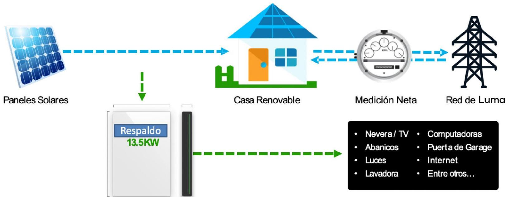
Durante todo el día, su sistema de energía solar alimenta su hogar y mantiene su batería cargada. El excedente de energía se va a la Red de AEE y duran te la noche la AEE le devuelve la energía acumulada mediante el Programa de Medición Neta.
