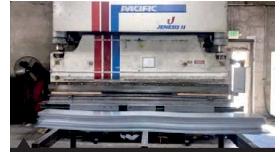
Press Brake of 14' y 220 tons CNC.
