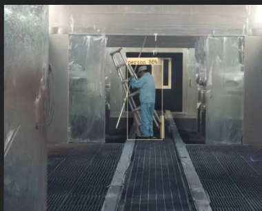
区域内入侵检测
