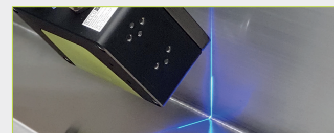
ECCO传感器进行焊缝检测
