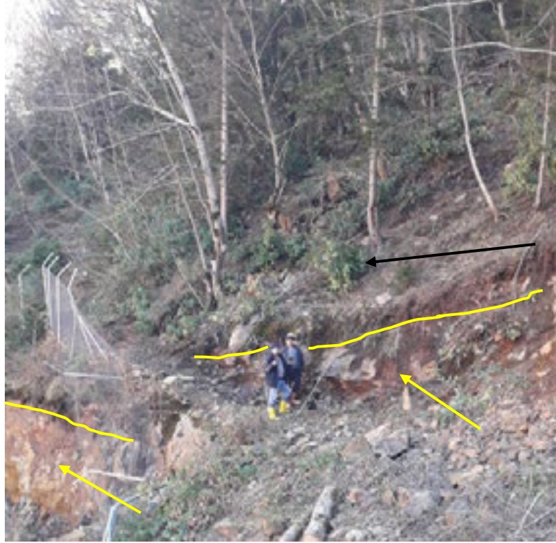
Resim 346. 5. Saha ziyareti esnasında incelenen HES sol sahil zerindeki limonitik zon (demir řapka, siyah ok ile) ile hemen altında yer alan yoęun pirit zon (sari oklar ile)
