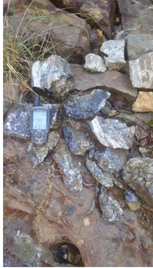
Resim 333. Önceki dönemde yapılan örneklemelerde düşey yönlü epitermal damarlar ve çok yüksek kurşun – çinko ve altın değerleri yakalanmıştır.
