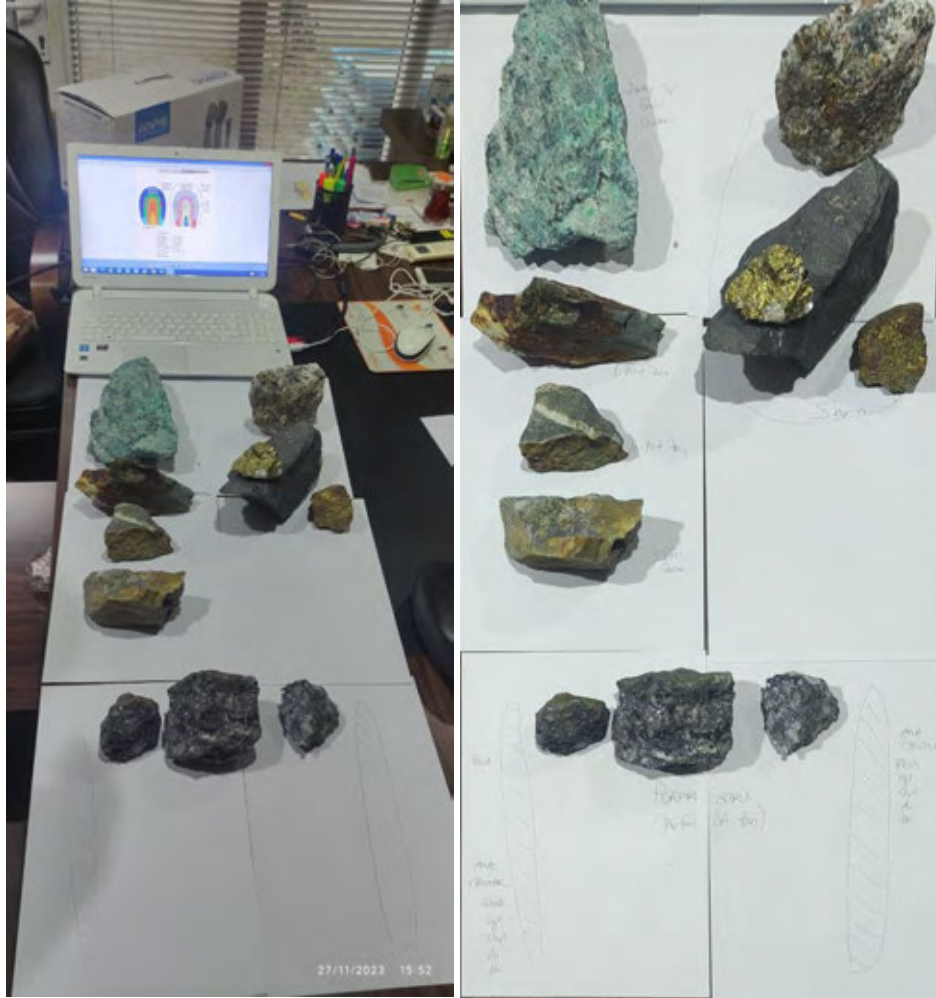
Resim 335. Bölgede yapılan örneklemlerde düşey yönlü epitermal damarlardan alınan el numuneleri (yüksek demir - kurşun – çinko – bakır ve potansiyel olarak altın ve gümüş değerli)
