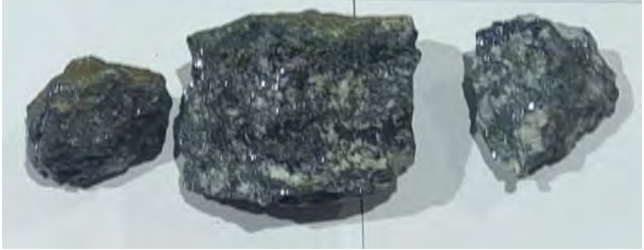
Resim 334. Önceki dönemde yapılan örneklemlerde düşey yönlü epitermal damarlardan alınan el numuneleri (yüksek kurşun – çinko – bakır ve altın değerleri gelmiştir)
