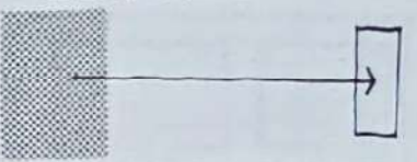
EL ESTACIONAMIENTO A CIERTA DISTANCIA DEL EDIFICIO UNIDOS POR UN TRANSPORTE
