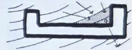
DRENE EL AGUA ESTANCADA POR DEBAJO DEL EDIFICIO
