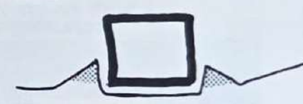
PROTEGER AL EDIFICIO DE TALUDES
