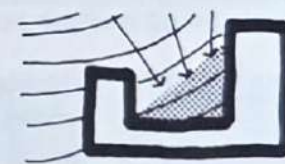
EVITAR EL ESTANCAMIENTO DE AGUA
