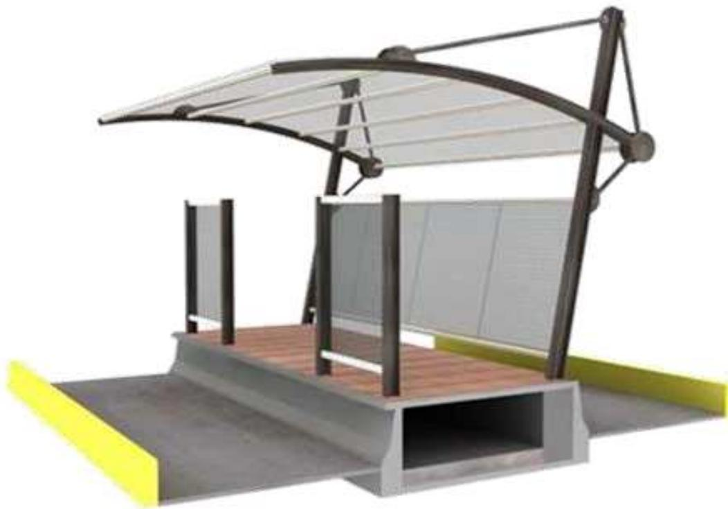
Perspectiva de cubierta con un apoyo para sistema de transporte Metrobus. Corredor Insurgentes
