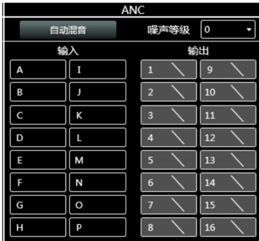
1、自动混音：开启时，自动混音信号输入到ANC本地信号。
