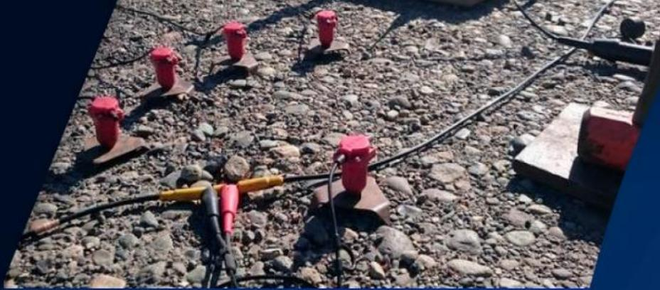
La **refracción por Micro-tremores** realiza mediciones in situ de perfiles de velocidad de ondas de corte  $V_s$  usando registros de ruido ambiental.
