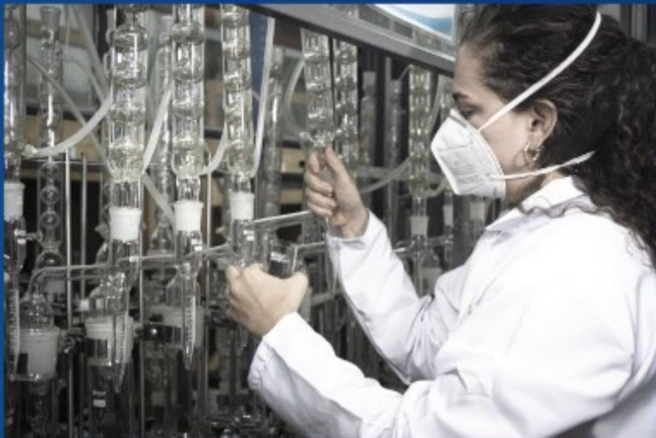
Determinación de porosidad y permeabilidad en tapones de pulgada y pulgada y media de diámetro, saturación de fluidos, gravedad específica API, densidad de granos, densidad de roca con diferentes fluidos. Extracción Hidrocarburos mediante Dean Stark y limpieza de HC por metodo Soxhlet.
