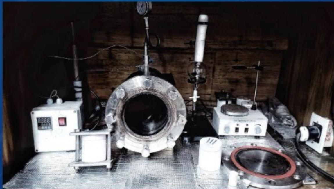
Termoreactor avanzado, disponible para una variedad de experimentos geocientíficos. Nuestro equipo, ubicado en el laboratorio, opera a temperaturas de hasta 200°C y presiones de hasta 200 psi.
