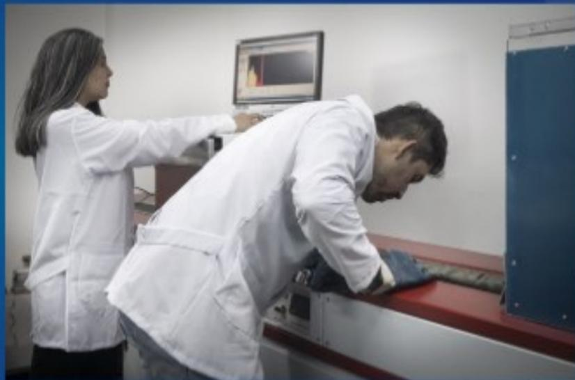
Es un equipo que determina la concentración de varios isotopos radioactivos en una muestra de roca. Se miden las concentraciones de Uranio, Torio, Potasio y la radiación total de la roca. Estos datos se pueden comparar y correlacionar con los registros de pozo e identificar zonas de interés. La mayor utilidad se da en zonas de extracción de petróleo, en donde se quiere conocer la columna estratigráfica. Equipo de adquisición: Core gamma espectral
