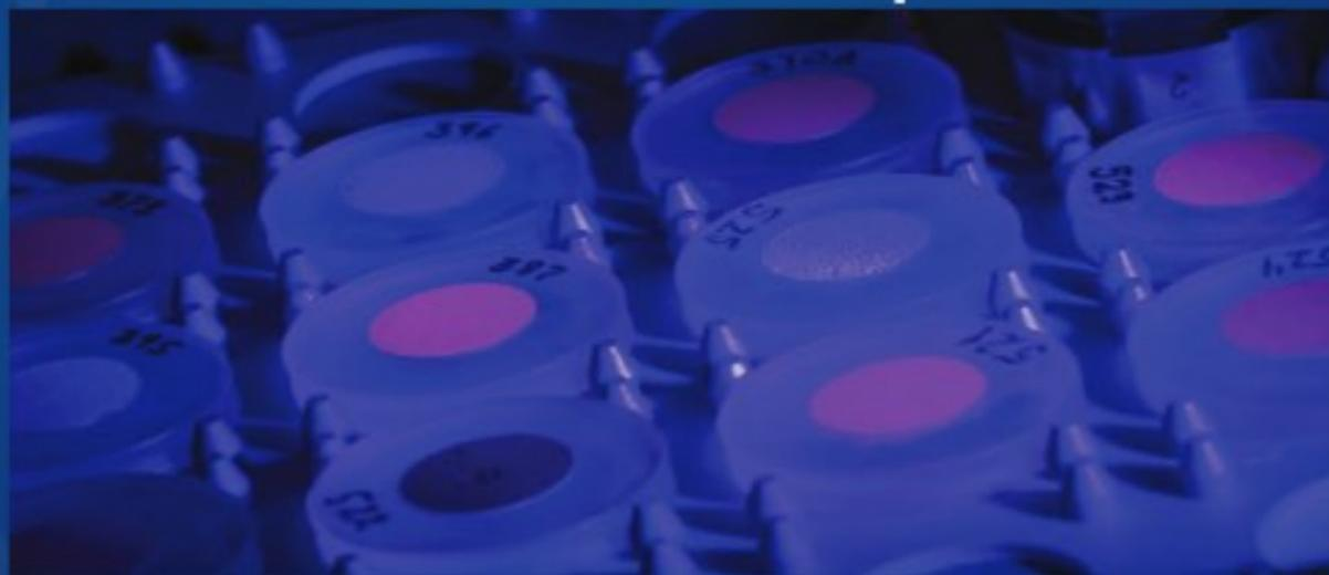
Los laboratorios de Gmas cuentan equipos de alta resolución para fluorescencia de rayos X de onda dispersiva (WDS-XRF) para análisis cuantitativo de elementos mayores y trazas en muestras sólidas y líquidas. La técnica se basa en la emisión de fotones de longitud de onda característica de cada elemento como consecuencia de la excitación por rayos X. La emisión se da en los niveles electrónicos de alta energía.
