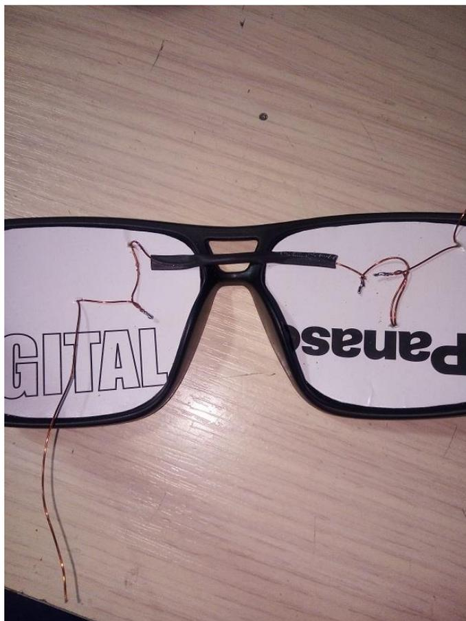
Соединяем катушки между собой проводами и пропаиваем обязательно. У нас остается два провода которые будут подключены к генератору сигналов.
