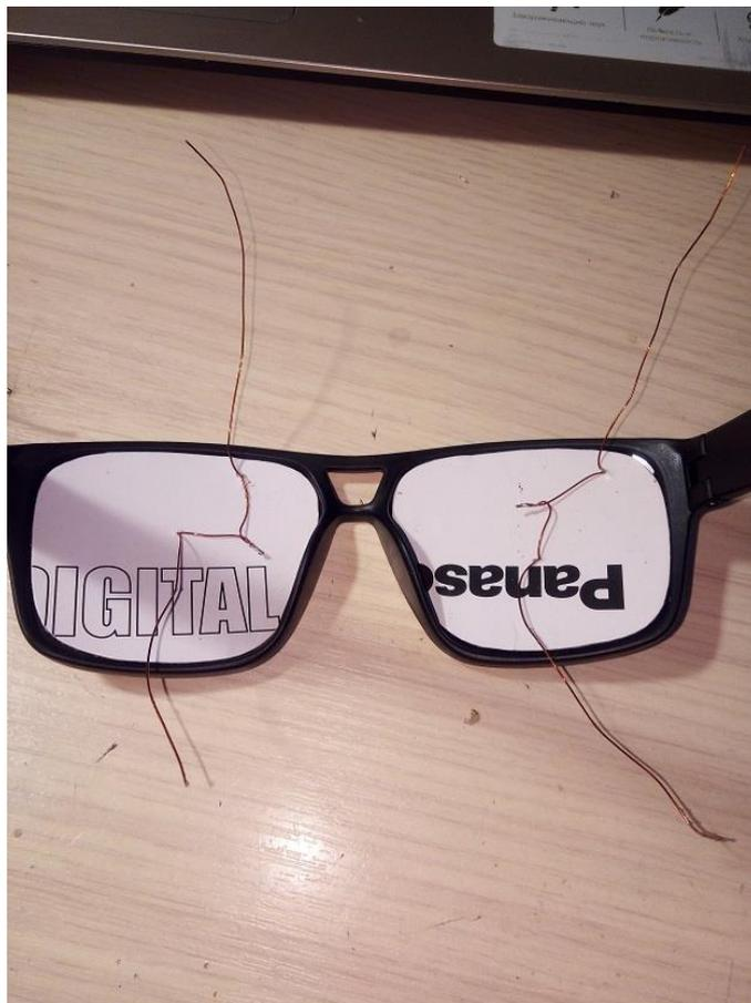
Внимание. Нужно соединить на каждой из катушек начало одного провода с концом другого. И обязательно пропаять.
