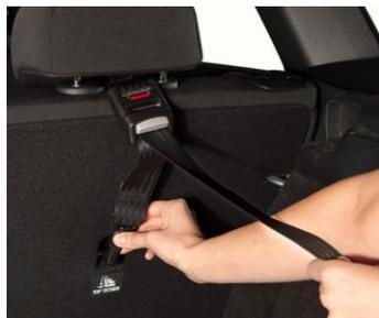
evita que se desplace hacia adelante en caso de una colisión. Para poder ser usado, es necesario que el SRI disponga de la correa y que el vehículo tenga el anclaje.
